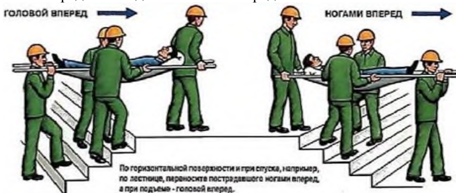
Рис. Подъём пострадавшего вверх (спуск вниз) по лестничному пролету.
